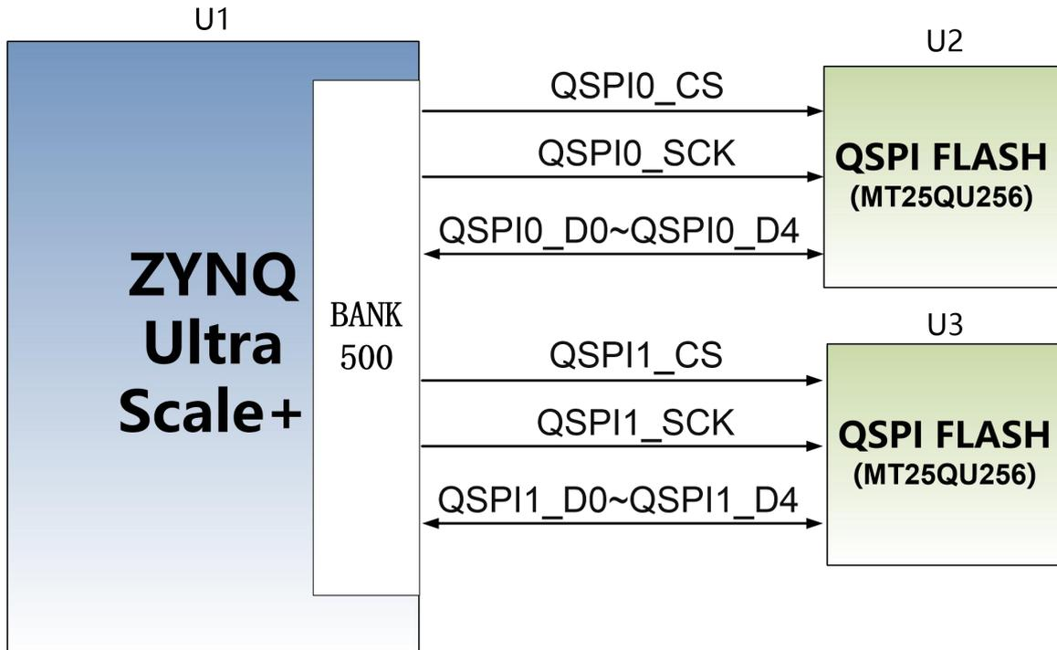
图 2-4-1 QSPI Flash 连接示意图
