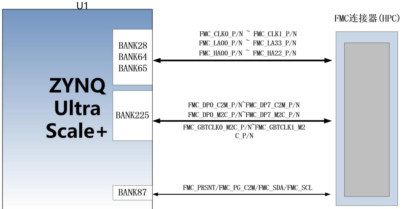
图 3-9-1 FMC 连接器连接示意图
