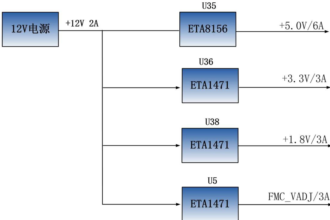
图 3-16-1 原理图中电源接口部分
