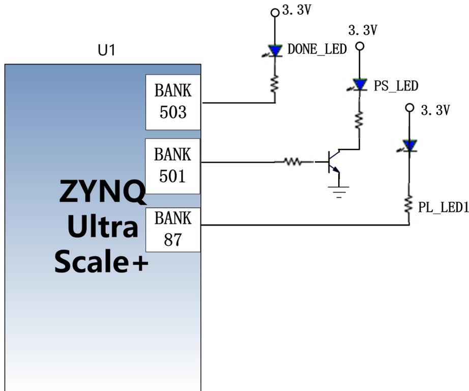
图 3-13-1 用户 LED 灯硬件连接示意图
