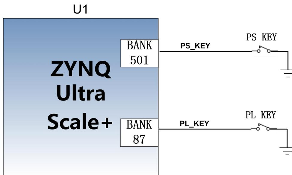
图 3-14-1 复位按键连接示意图
