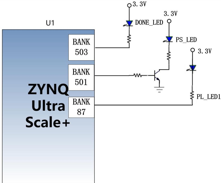
图3-15-1用户LED灯硬件连接示意图
