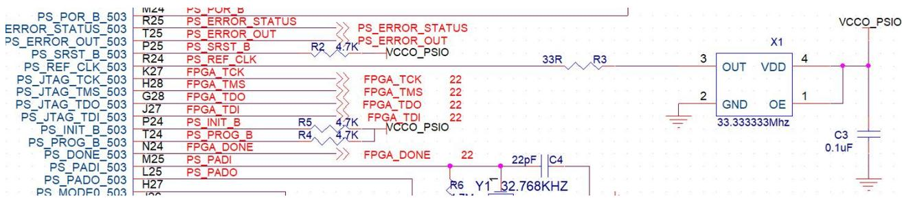
图 2-6-3 PS 部分的有源晶振
