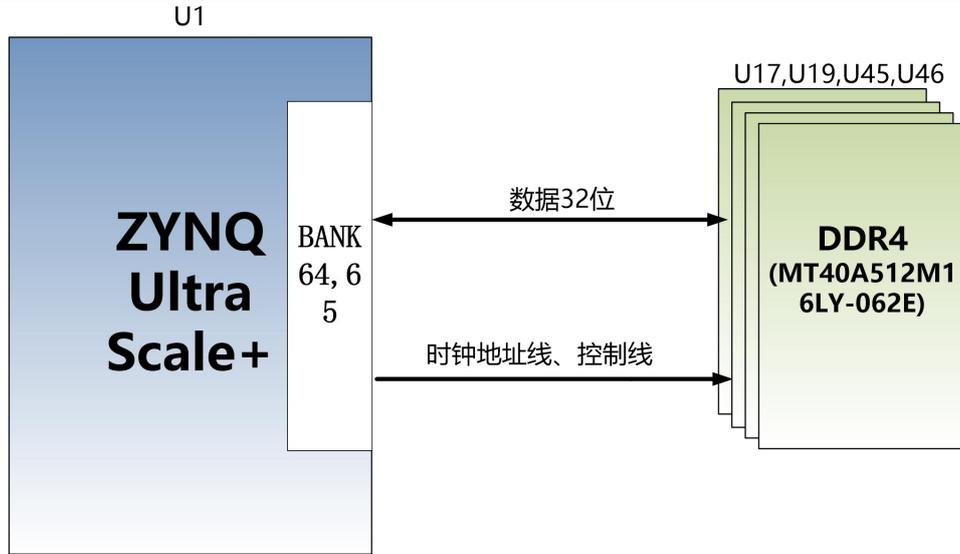
图 2-3-2 PL 端 DDR4 DRAM 原理图部分
