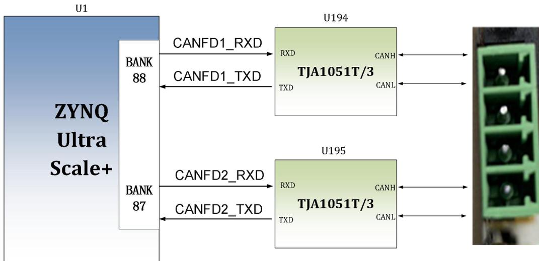
图 3-10-1 PL 端 CAN 收发芯片的连接示意图
