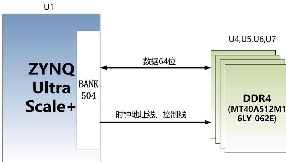
图 2-3-1 PS 端 DDR4 DRAM 原理图部分
