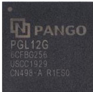
图 2-2-1 FPGA 芯片实物
