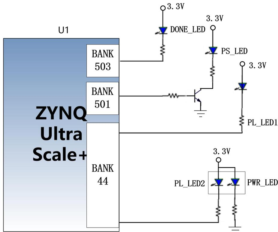
图 3-17-1 用户 LED 灯硬件连接示意图
