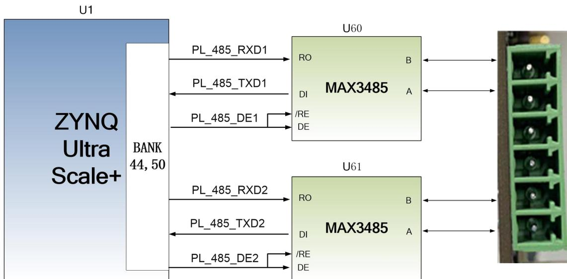
图 3-10-1 PL 端 485 通信的连接示意图
