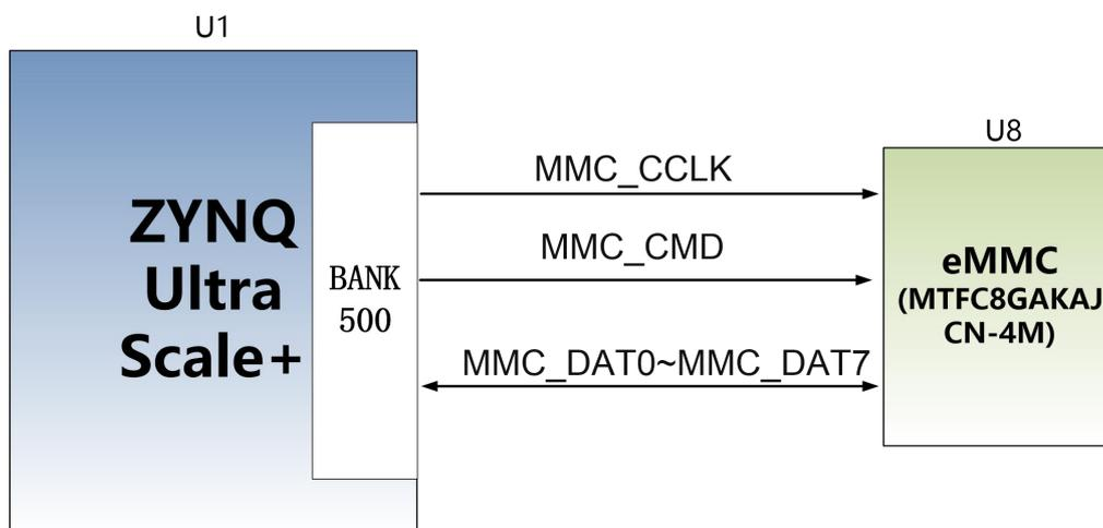
图 2-5-1 eMMC Flash 连接示意图
