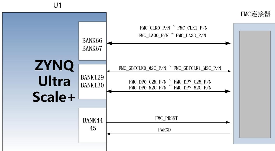
图 3-12-1 FMC 连接器连接示意图
