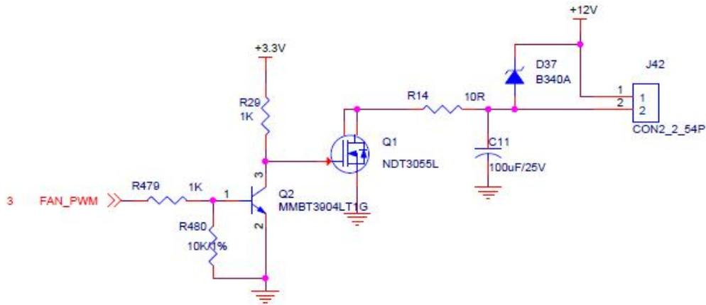
图 3-21-1 开发板原理图中风扇设计
