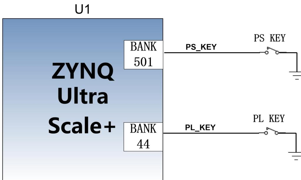
图 3-18-1 复位按键连接示意图
