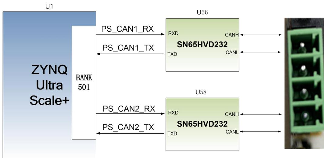
图 3-9-1 PS 端 CAN 收发芯片的连接示意图
