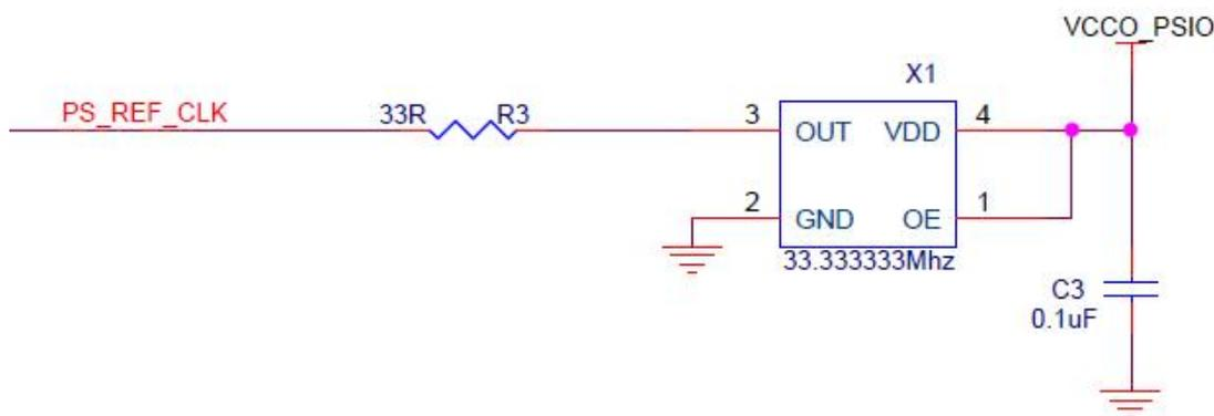
图 2-6-3 PS 部分的有源晶振
