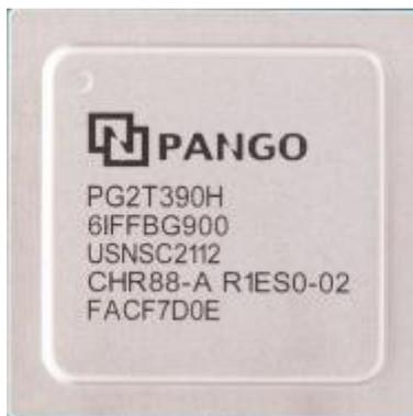
图 2-2-1 FPGA 芯片实物
