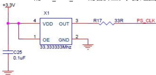
图 2-6-2 PS 部分的有源晶振
