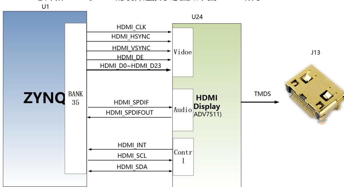
图 3-5-1 HDMI 输出接口设计原理图
