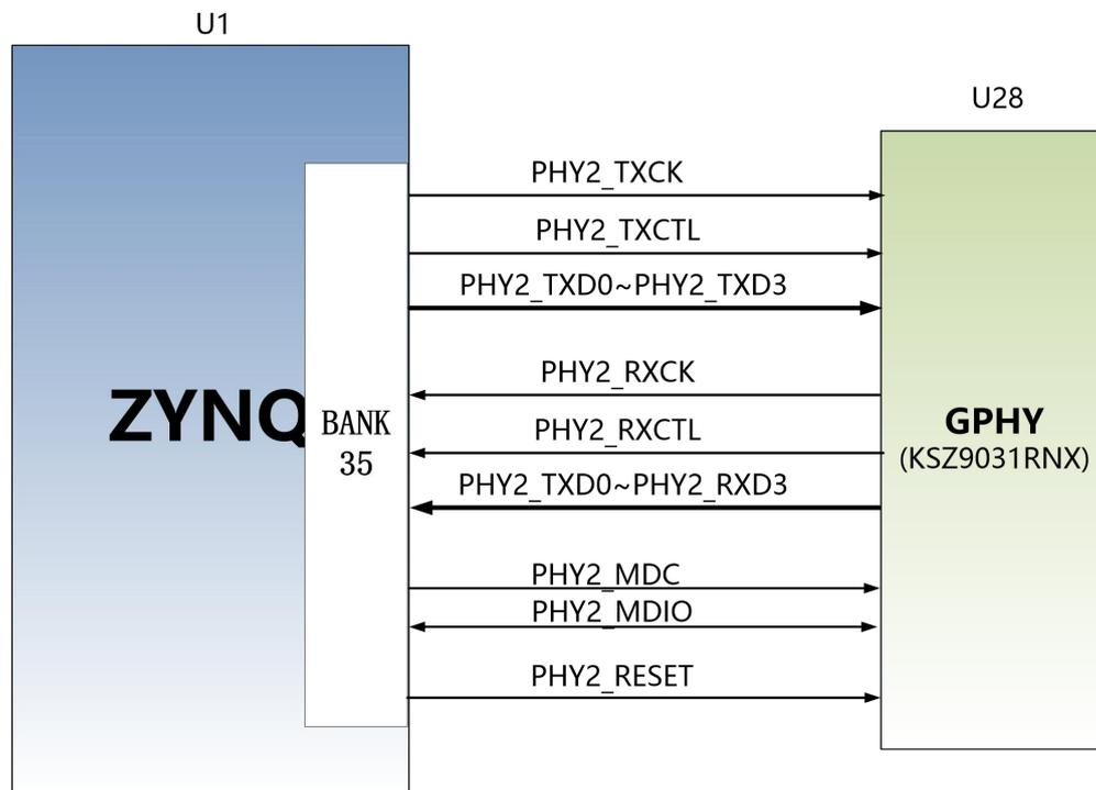
图 3-3-2 ZYNQ PL 端与 GPHY 连接示意图
