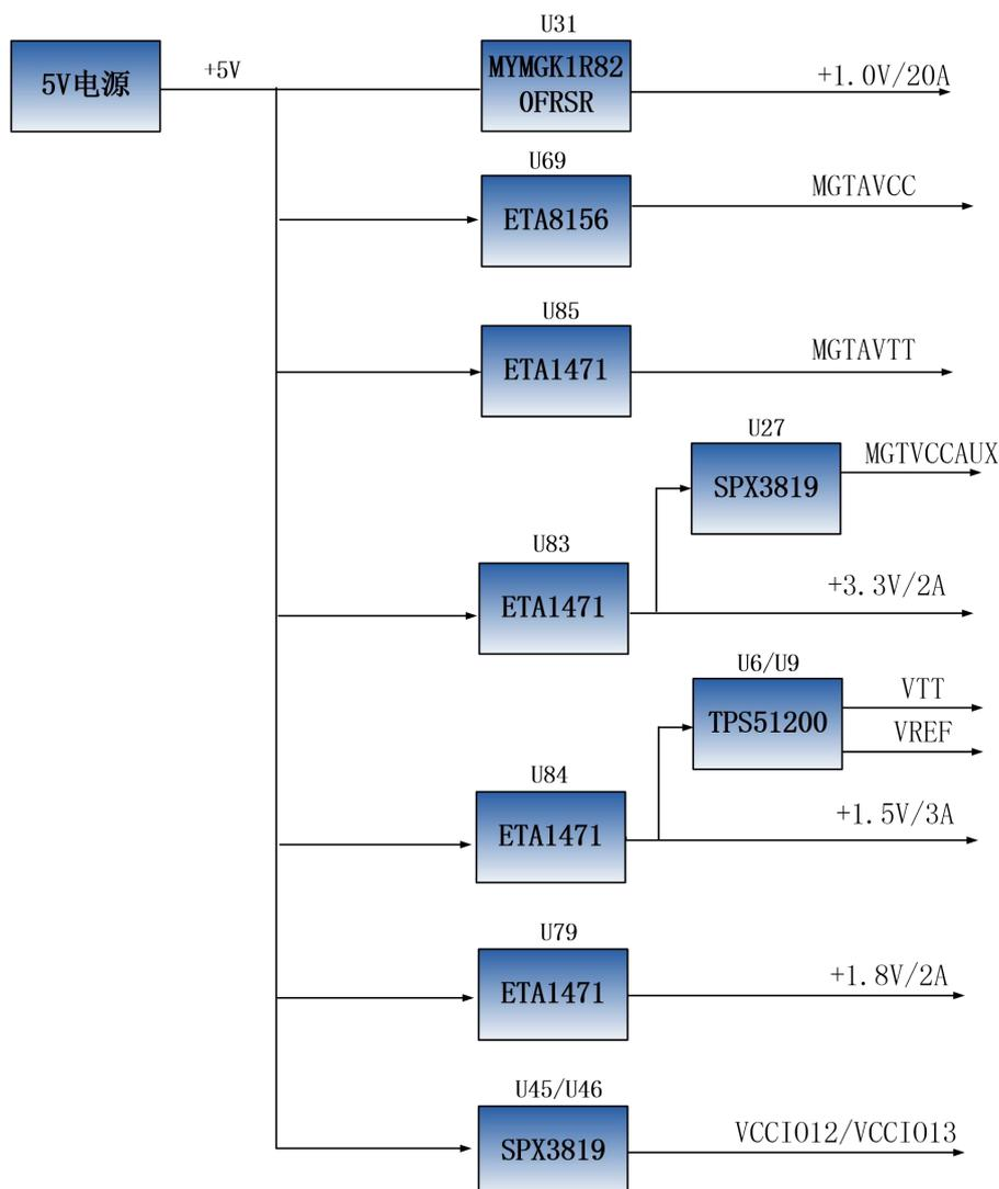
图 2-9-1 原理图中电源接口部分
