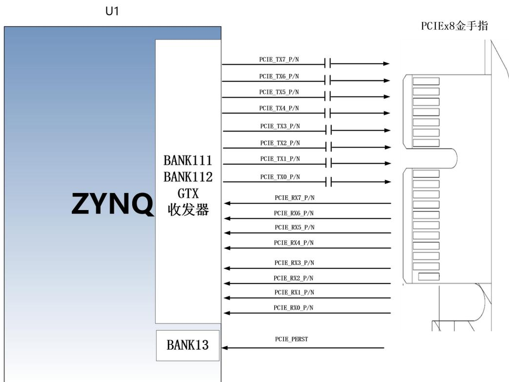
图 3-8-1 PCIe 插槽设计示意图
