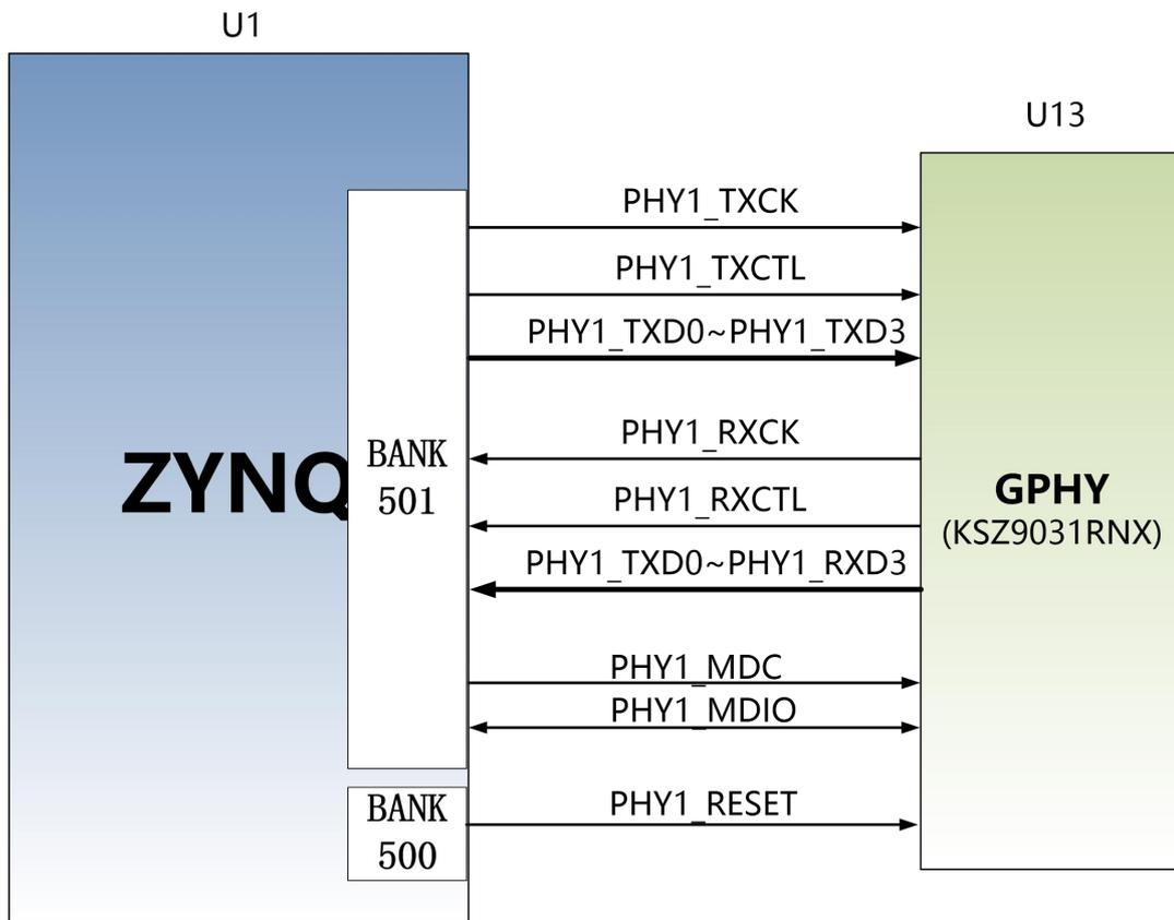
图 3-3-1 ZYNQ PS 系统与 GPHY 连接示意图
