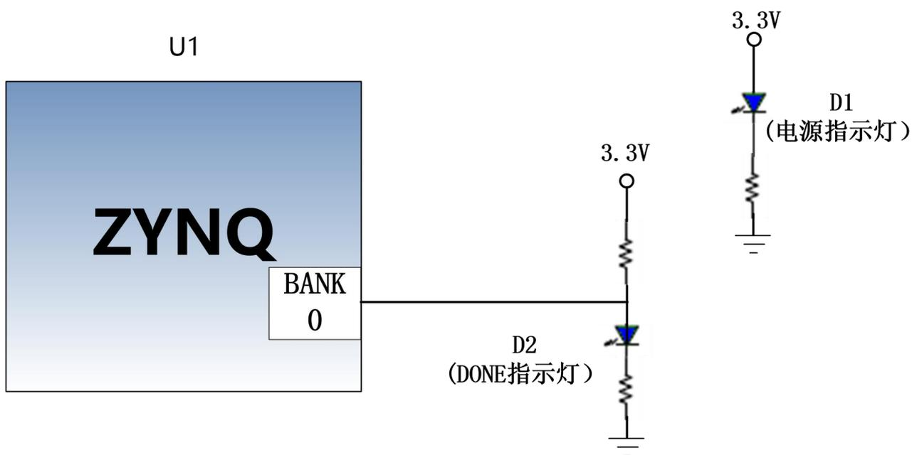
图 2-7-1 核心板 LED 灯硬件连接示意图
