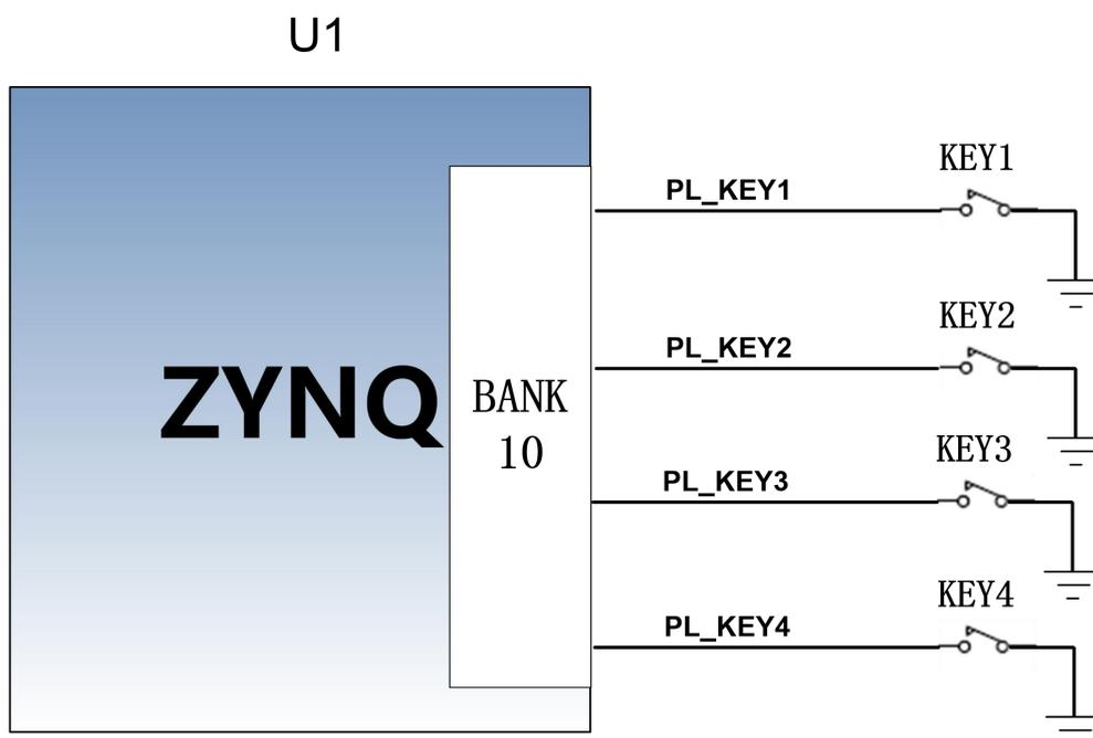
图 3-12-1 复位按键连接示意图
