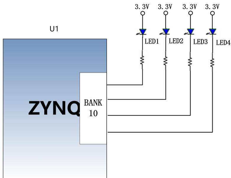
图 3-11-1 用户 LED 灯硬件连接示意图
