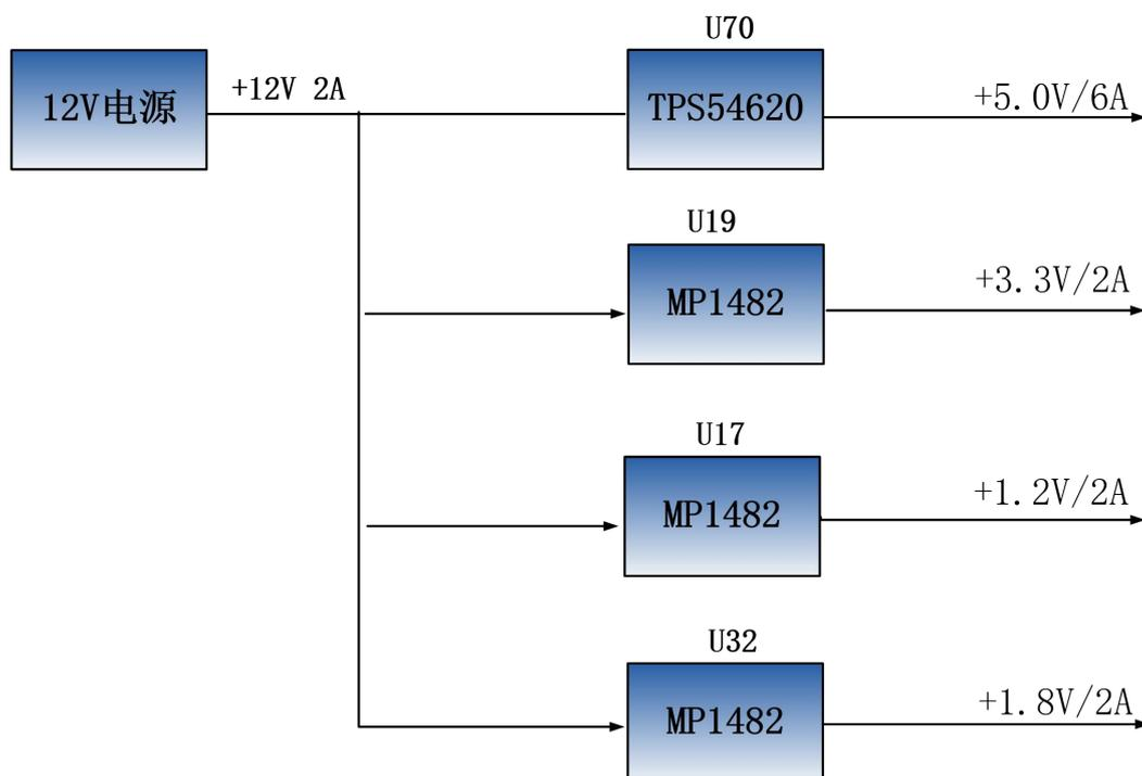
图 3-15-1 原理图中电源接口部分
