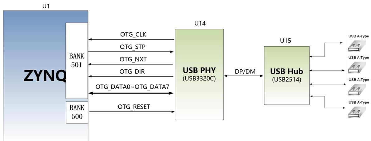
图 3-4-1 Zynq7000 和 USB 芯片间连接示意图
