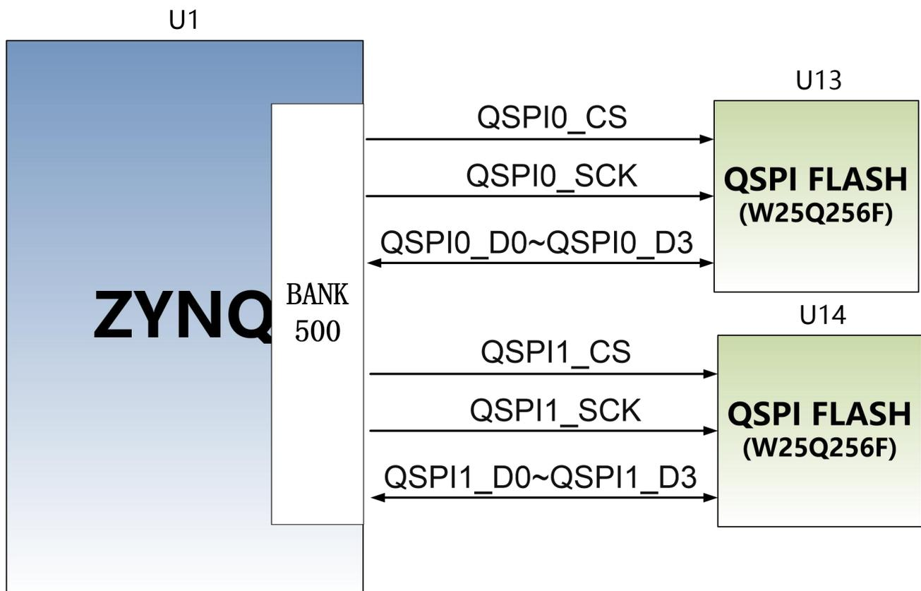
图 2-4-1 QSPI Flash 连接示意图
