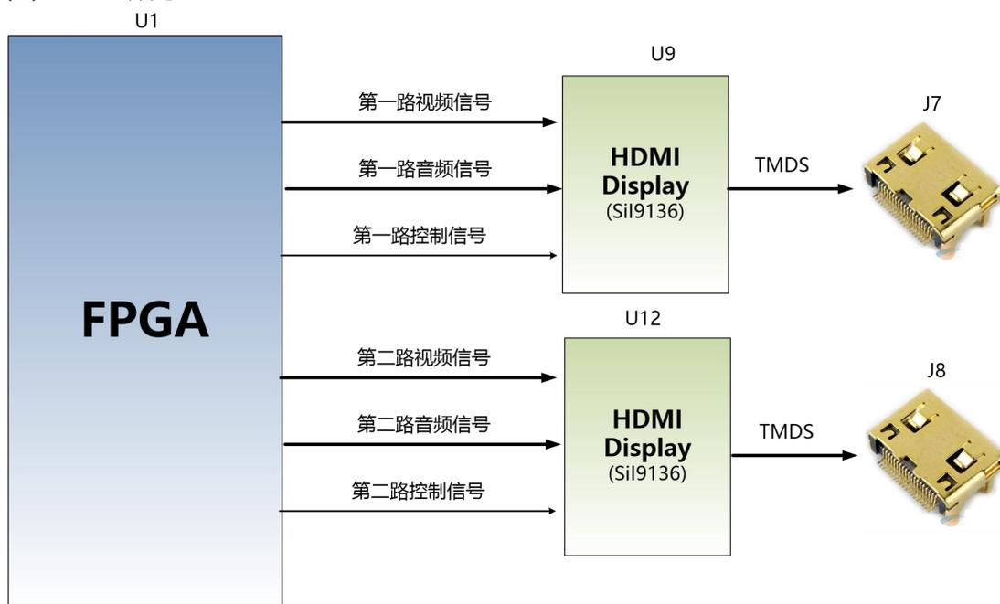
图 3-3-1 HDMI 输出接口设计原理图
