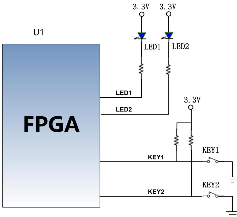
图 3-9-1 用户 LED 灯和按键硬件连接示意图
