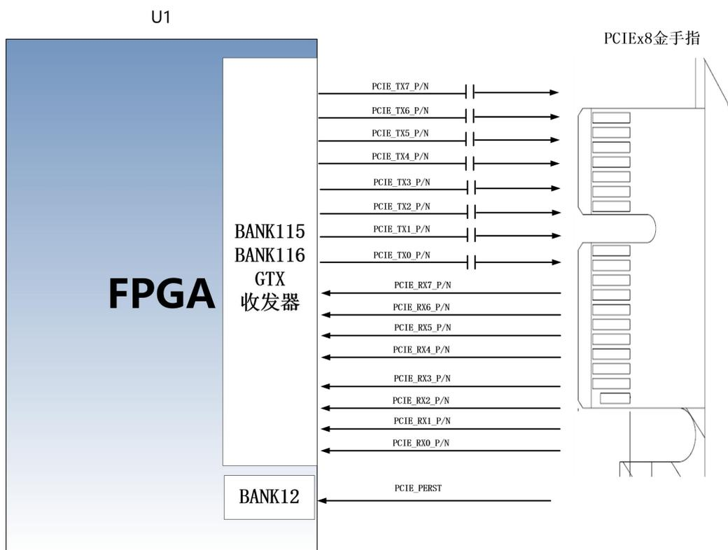
图 3-2-1 PCIe 插槽设计示意图
