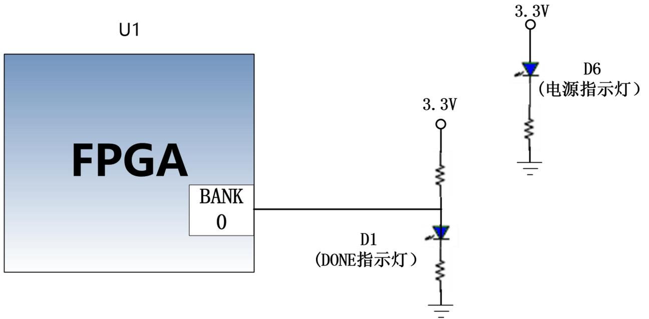
图 2-6-1 核心板 LED 灯硬件连接示意图
