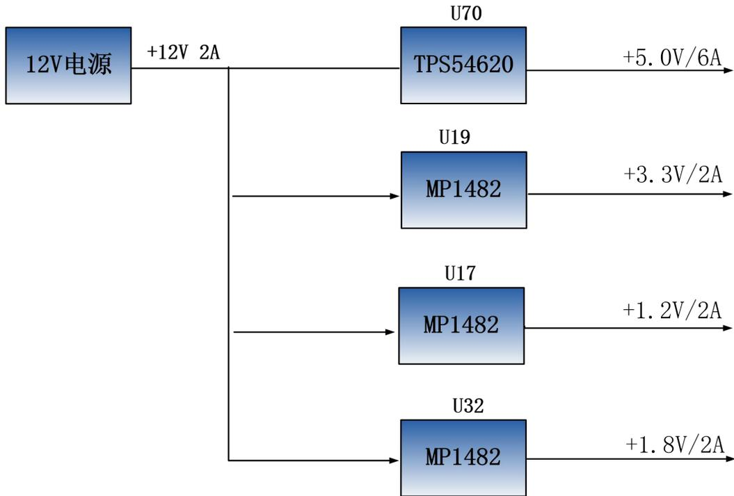
图 3-11-1 原理图中电源接口部分
