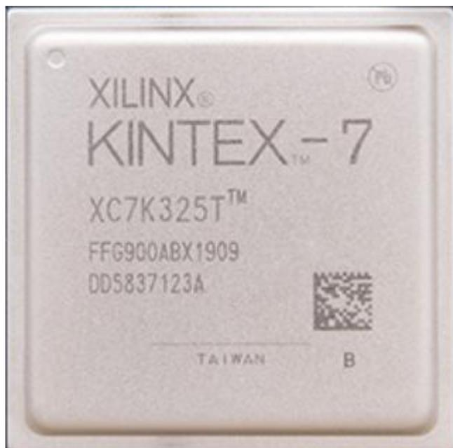
图2-2-2 KINTEX-7 FPGA芯片实物
