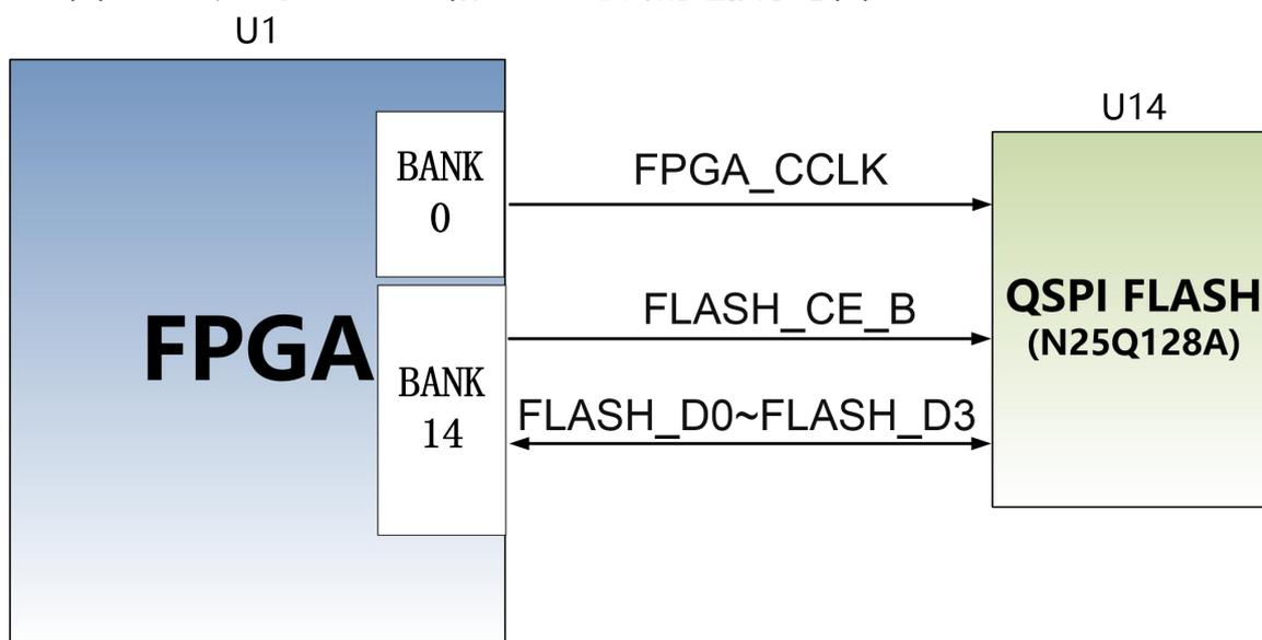
图 5-1 QSPI Flash 连接示意图
