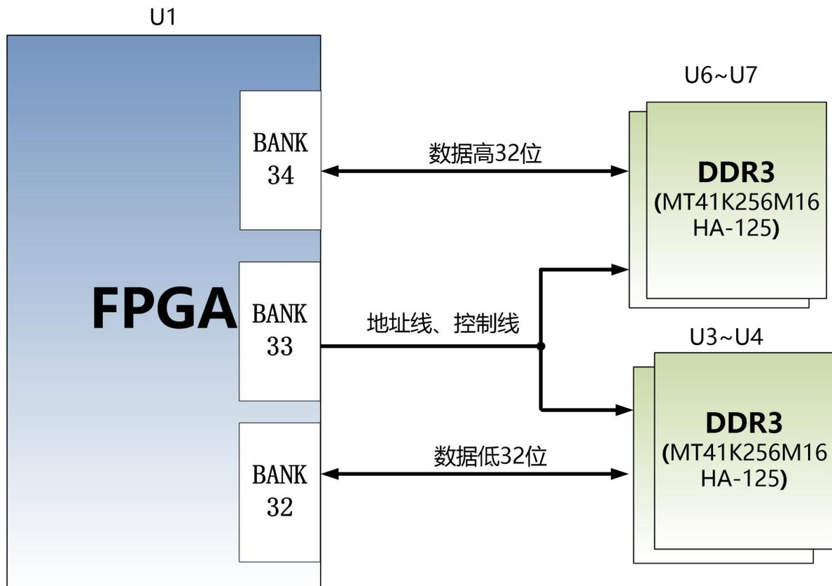
图2-3-1 DDR3 DRAM原理图部分
